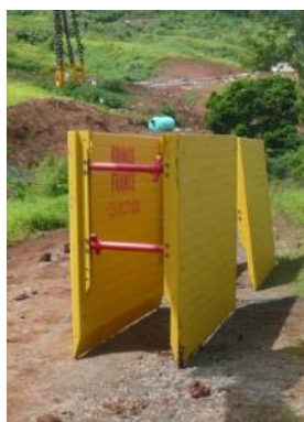
2 vérins à chacune des extrémités du caisson de base
