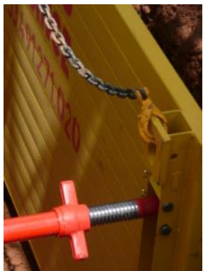
Manutenionner par les crochets de levage
