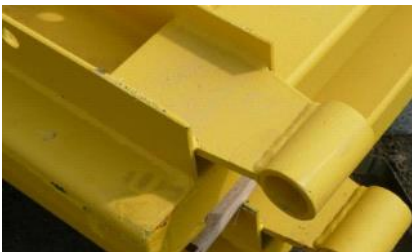
Fixation de la rehausse, la pièce de jonction fait partie intégrante de la rehausse
