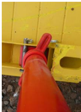
Fixer les goupilles à l'intérieur du caisson
